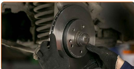
**23** Serrez l'attache du disque de frein. Utilisez la clé HEX n° H5. Utilisez une clé dynamométrique. Serrez-le jusqu'à 9 Nm.
