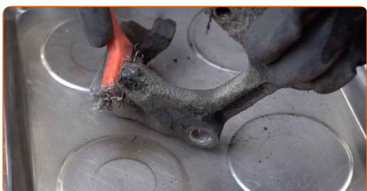
**29** Appliquez du produit sur les boulons de serrage. Utilisez un enduit.
