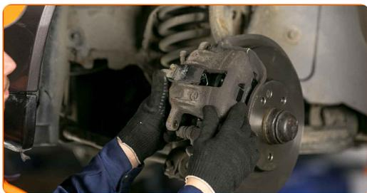
**20** Installez les boulons de fixation (2 pièces).
