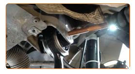
Connectez le joint rotule à la fusée d'essieu.
