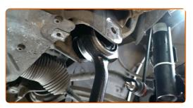
Remplacement : bras inférieur avant – Mercedes W203. Les professionnels recommandent :
