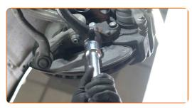
Vissez la fixation reliant la bras de suspension au cadre auxiliaire. Utilisez une clé mixte de No.21 Utilisez une douille n° 21. Utilisez une clé à cliquet.
