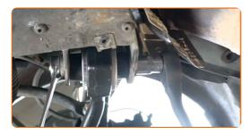
Serrez la fixation arrière qui raccorde le bras au châssis. Utilisez une clé mixte de No.21 Utilisez une douille n° 21. Utilisez une clé dynamométrique. Serrez-le jusqu'à 80 Nm.+120°
