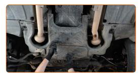
Serrez les fixations du carénage sous moteur. Utilisez une douille n° 8. Utilisez une clé à cliquet.
