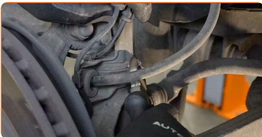
**14** Débranchez les fils du capteur d'ABS.
