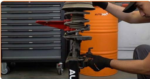
Remplacement : jambe de suspension – Mercedes W203. Les experts d'AUTODOC recommandent :
