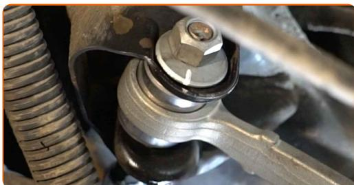
**21** Vissez la fixation reliant le bras de suspension au cadre auxiliaire. Servez vous de la douille XZN n°12. Utilisez une douille n° 19. Utilisez un porte-taraud.
