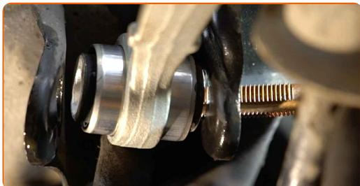
**18** Attachez le joint à rotule de la fusée arrière.
