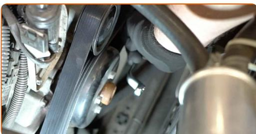
**10** Installez la courroie striée en V sur le tendeur.
