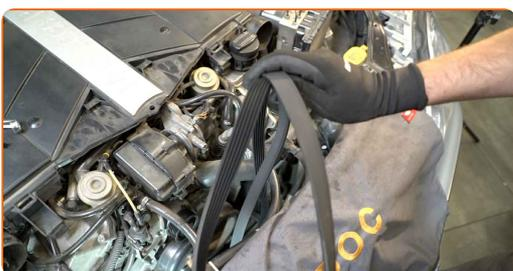
**Remplacement : courroie poly V – Mercedes W203. AUTODOC recommande :**
