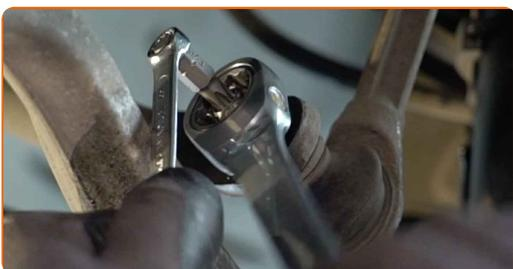
**8** Dévissez la fixation reliant la biellette à l'amortisseur. Utilisez une douille n° 18. Utilisez une clé à cliquet.
