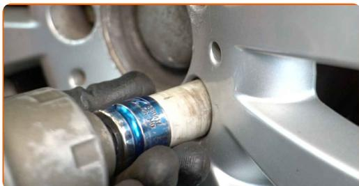
**20** Abaissez la voiture et serrez les boulons de roue en ordre croisé. Servez-vous d'une douille à choc pour roue N°17. Utilisez une clé dynamométrique. Serrez-le jusqu'à 130 Nm.
