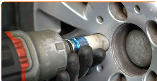
**58** Abaissez la voiture et serrez les boulons de roue en ordre croisé. Servez-vous d'une douille à choc pour roue N°17. Utilisez une clé dynamométrique. Serrez-le jusqu'à 130 Nm.
