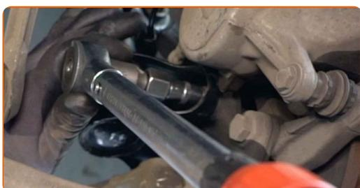
**47** Serrez les fixations inférieures qui relient l'amortisseur à la fusée d'essieu. Utilisez la mèche Torx E14. Utilisez une clé dynamométrique. Serrez-le jusqu'à 100 Nm.
