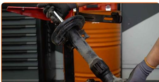
**31** Installez le nouvel amortisseur sur le compresseur à ressort hydraulique hélicoïdal.
