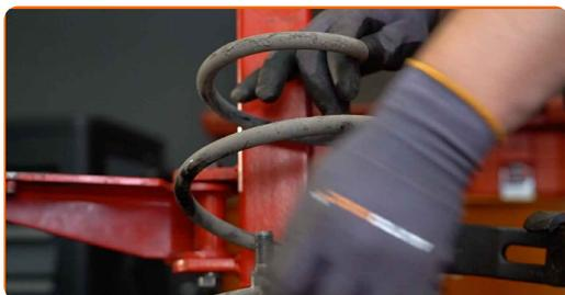
**30** Retirez l'amortisseur usagé du compresseur à ressort hydraulique hélicoïdal.
