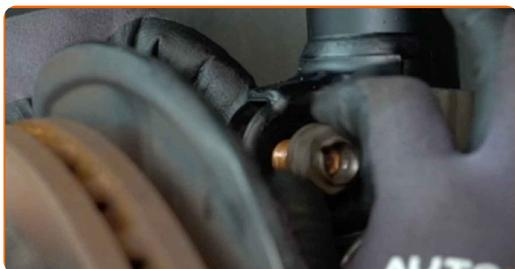
**46** Serrez les fixations inférieures qui relient l'amortisseur à la fusée d'essieu. Utilisez une douille n° 21. Utilisez la mèche Torx E18. Utilisez une clé dynamométrique. Serrez-le jusqu'à 100 Nm.+90°
