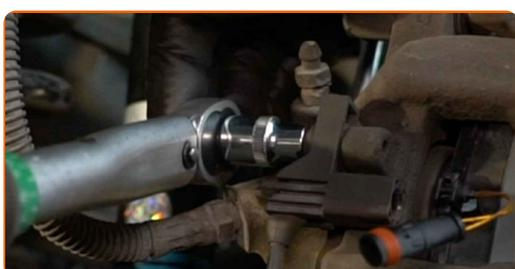
**47** Appliquez du produit sur le bouchon du capteur d'usure des plaquettes de frein. Utilisez de la graisse diélectrique.
