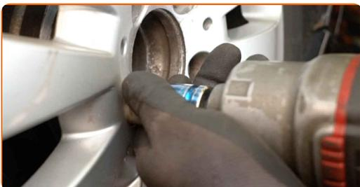
**53** Abaissez la voiture et serrez les boulons de roue en ordre croisé. Servez-vous d'une douille à choc pour roue N°17. Utilisez une clé dynamométrique. Serrez-le jusqu'à 130 Nm.
