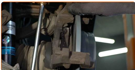
**35** Installez les boulons de fixation.
