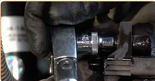
**10** Retirez l'écrou de fixation.
