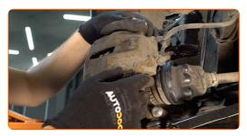
Serrez les fixations de l'étrier de frein. Utilisez une douille n° 12. Utilisez une clé dynamométrique. Serrez-le jusqu'à 27 Nm.
