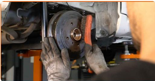
**24** Appliquez du produit sur la surface de contact entre la jante et le tambour de frein. Utilisez de la graisse au cuivre.
