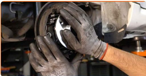
**17** Serrez la fixation du palier de moyeu de roue. Utilisez une douille n° 12. Utilisez une clé dynamométrique. Serrez-le jusqu'à 60 Nm.
