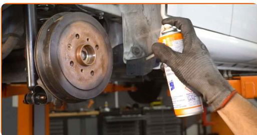
**25** Traitez les attaches du roulement de moyeu de roue. Utilisez de la graisse au cuivre.
