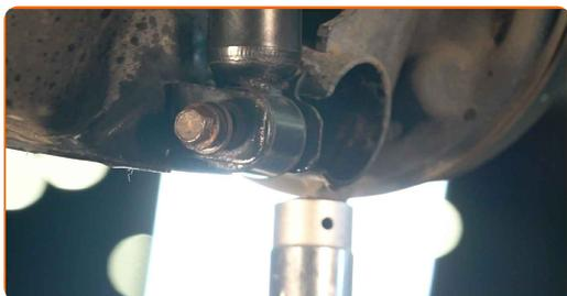
**25** Serrez l'attache inférieure de l'amortisseur. Utilisez une douille n° 14. Utilisez une clé dynamométrique. Serrez-le jusqu'à 48 Nm.
