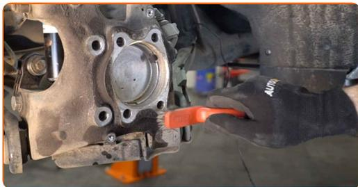
**24** Appliquez une graisse spéciale sur l'emplacement du palier de roulement. Utilisez de la graisse au cuivre.
