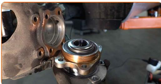
**25** Installez le nouveau moyeu de roue avec un roulement.
