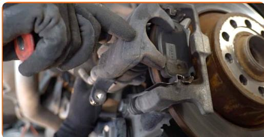
Remplacement : roulement de roue – Audi A6 4F2. AUTODOC recommande :
