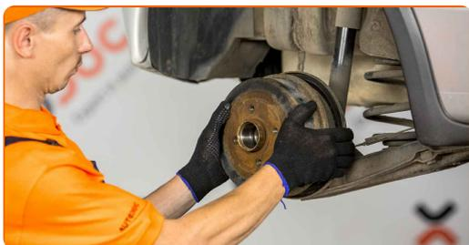
**23** Serrez le moyeu. Utilisez une douille n° 27. Utilisez une clé dynamométrique. Serrez-le jusqu'à 175 Nm.
