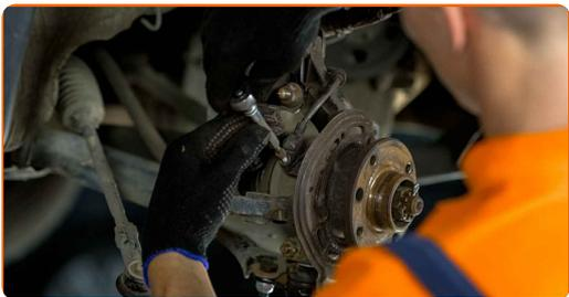
**44** Connectez l'extrémité du tirant à la fusée d'essieu.
