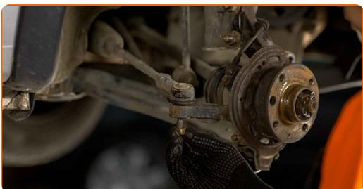
**45** Serrez l'écrou de fixation reliant l'embout de biellette de direction à la fusée d'essieu. Utilisez une douille n° 16. Utilisez une clé dynamométrique. Serrez-le jusqu'à 35 Nm.
