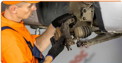
**35** Connectez le joint rotule à la fusée d'essieu.
