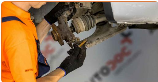
**38** Serrez l'attache inférieure de l'amortisseur. Utilisez une clé mixte de No.18. Utilisez une douille n° 18. Utilisez une clé dynamométrique. Serrez-le jusqu'à 80 Nm.+75°
