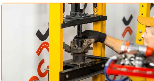
Remplacement : roulement de roue – Opel Corsa C. Les experts d'AUTODOC recommandent :
