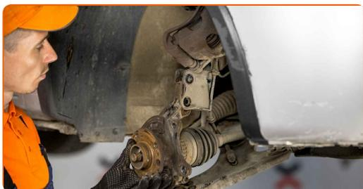
**36** Installez l'écrou de fixation.
