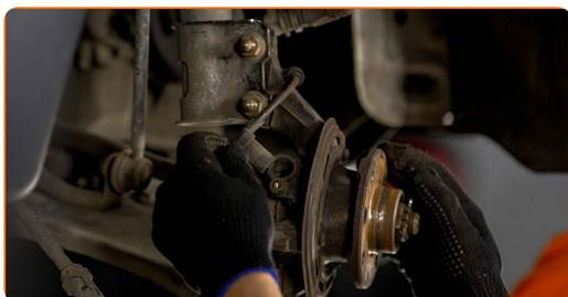
**43** Vissez la fixation reliant le capteur ABS à la fusée arrière. Utilisez la clé HEX n° H5. Utilisez une clé à cliquet.
