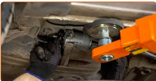
Remplacement : filtre à carburant – Opel Corsa C. Conseil :
