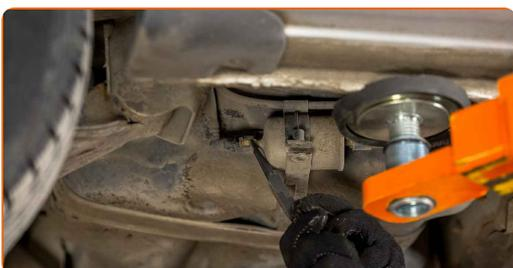
Remplacement : filtre à carburant – Opel Corsa C. Conseil d'AUTODOC :
