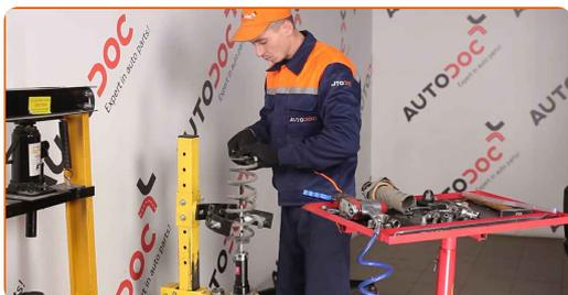
40 Installez le support, le soufflet anti-poussière et la butée de limitation sur un nouvel amortisseur.
