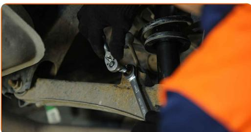
**66.1** Installez le support du sous-châssis. Serrez ses boulons.
