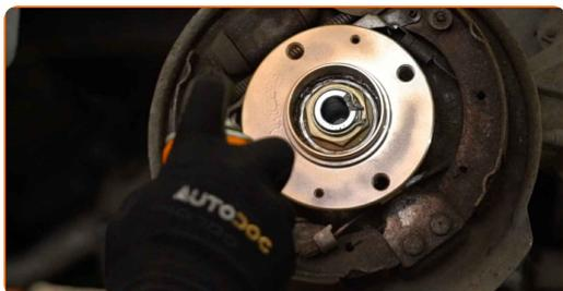
**18** Installez le bouchon de protection du moyeu de roue. Servez-vous d'un maillet en caoutchouc.
