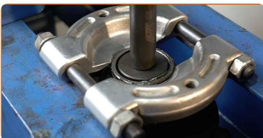
**46** Appuyez pour faire sortir le roulement de moyeu de la roue. Coffret de douilles et de roulements.
