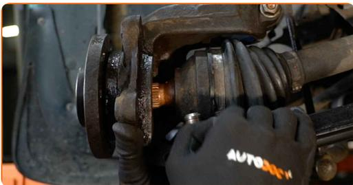
**61** Connectez le joint rotule à la fusée d'essieu.
