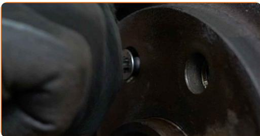
**75** Serrez les fixations du disque de frein. Utilisez la mèche Torx T30. Utilisez une clé dynamométrique. Serrez-le jusqu'à 10 Nm.
