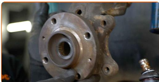
**42** Nettoyez la bague de retenue du roulement de moyeu de la roue. Utilisez une brosse métallique. Servez vous de l'aérosol WD-40.
