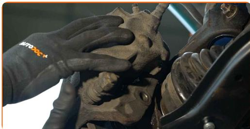
**77** Installez les boulons de fixation.
