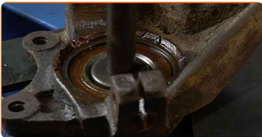
**44** Retirez l'anneau de retenue du palier de moyeu de roue. Utilisez les pinces à anneau de retenue.
