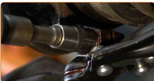
**28** Retirez l'écrou de fixation.
