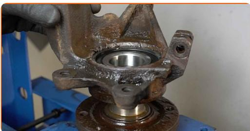
Remplacement : roulement de roue – CITROËN Berlingo / Berlingo First (MF, GJK, GFK). AUTODOC recommande :
