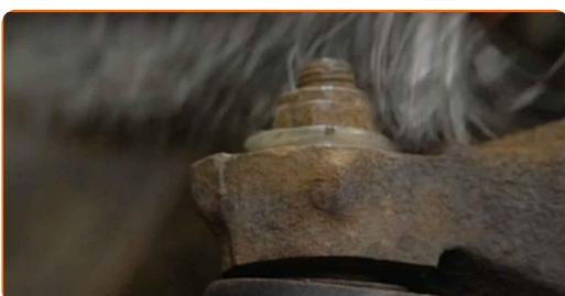
**30** Dévissez l'écrou d'attache d'extrémité à la fusée d'essieu. Utilisez une douille n° 17. Utilisez une clé à cliquet.
