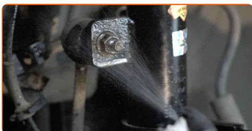
**8** Dévissez la fixation reliant la biellette à l'amortisseur. Utilisez une douille n° 15. Utilisez une clé à cliquet.
