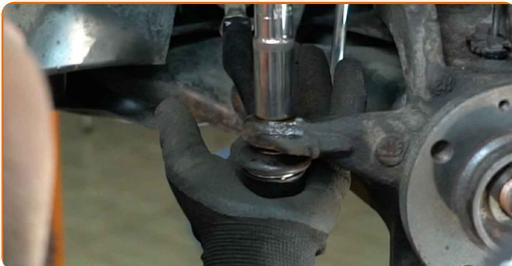
**73** Serrez l'écrou de fixation reliant l'embout de biellette de direction à la fusée d'essieu. Utilisez une douille n° 17. Utilisez une clé dynamométrique. Serrez-le jusqu'à 35 Nm.
