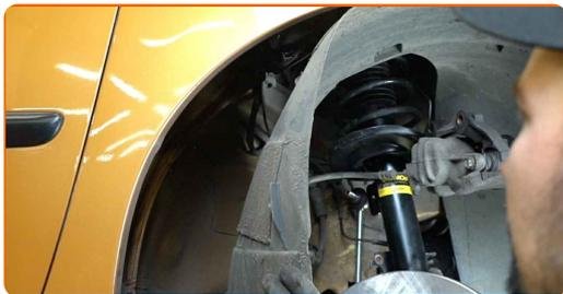
**22** Détachez le connecteur du capteur ABS.
