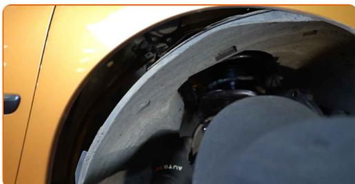
**69** Réinstallez les clips en plastique de la garniture du passage de roue.
