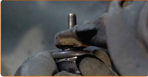
**72** Vissez l'écrou de fixation reliant l'embout de biellette à la fusée d'essieu. Utilisez une douille n° 17. Utilisez une clé à cliquet.
