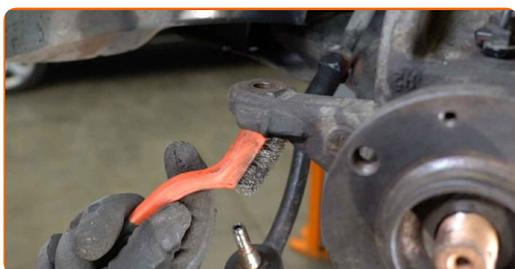
**71** Connectez l'extrémité du tirant à la fusée d'essieu.
