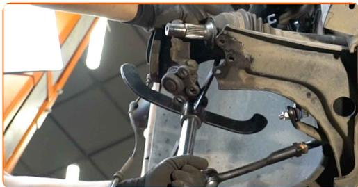
**58** Installez l'écrou de fixation.
