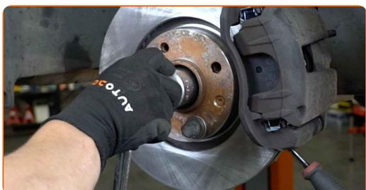
**8** Retirez l'écrou de fixation.
