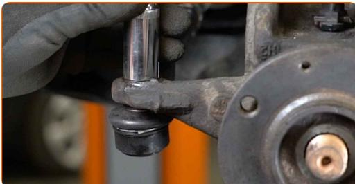
**74** Serrez les fixations reliant le joint à rotule au bras de commande. Utilisez une douille n° 16. Utilisez une clé dynamométrique. Serrez-le jusqu'à 60 Nm.
