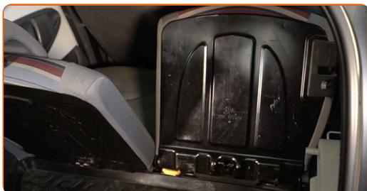
**4** Retirez les attaches de la garniture latérale du coffre. Utilisez un outil d'extraction de clips.
