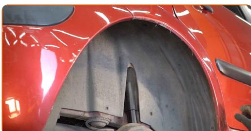
**31** Réinstallez les clips en plastique de la garniture du passage de roue.
