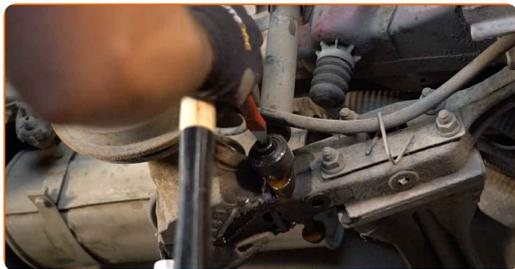
**15** Retirez l'écrou de fixation. Servez-vous d'un burin plat pour l'usinage des métaux. Servez-vous d'un marteau.
