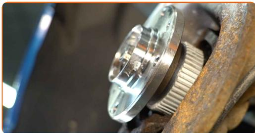
**23** Serrez le moyeu. Utilisez une douille n° 32. Utilisez une clé dynamométrique. Serrez-le jusqu'à 230 Nm.
