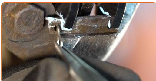
**34** Appliquez du produit sur la zone de contact entre le disque de frein et la jante. Utilisez de la graisse au cuivre.
