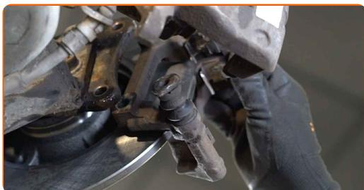
**30** Serrez le support de l'étrier de frein. Utilisez la mèche Torx T55. Utilisez une clé dynamométrique. Serrez-le jusqu'à 53 Nm.
