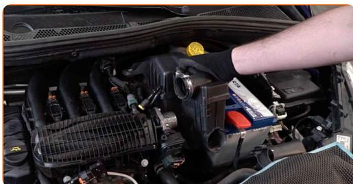
**16** CVissez les boulons de fixation du compartiment filtre. Utilisez une douille n° 10. Utilisez une clé à cliquet.
