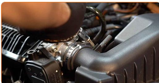
**5** Dévissez les boulons de fixation du compartiment du filtre. Utilisez une douille n° 10. Utilisez une clé à cliquet.
