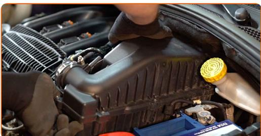
**8** Desserrez les trois vis de fixation du couvercle de filtre à air. Servez-vous d'un tournevis Phillips.
