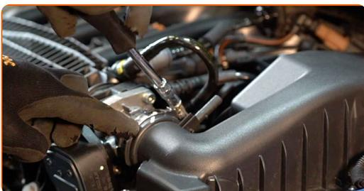
**18** Connectez le tuyau de ventilation du carter au conduit d'air.
