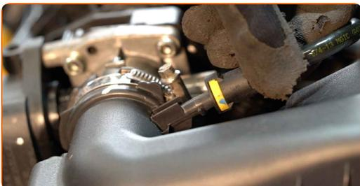
**19** Connectez le tuyau d'admission d'air au boîtier du filtre à air.
