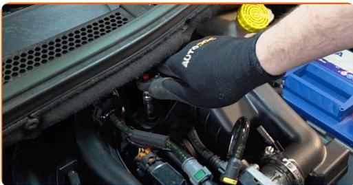
**17** Vissez le collier qui serre le boîtier de filtre à air du moteur au boîtier papillon. Utilisez une douille n° 7.
