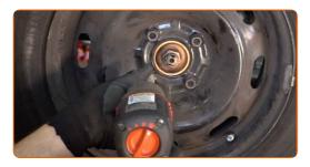
Abaissez la voiture et serrez les boulons de roue en ordre croisé. Utilisez une clé dynamométrique. Serrez-le jusqu'à 90 Nm.
