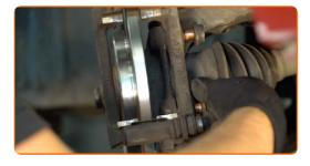
Serrez le support de l'étrier de frein. Utilisez la mèche Torx T55. Utilisez une clé dynamométrique. Serrez-le jusqu'à 105 Nm.
