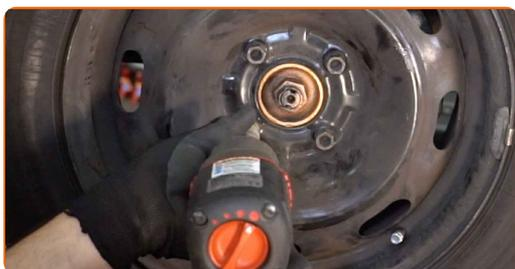
**32** Abaissez la voiture et serrez les boulons de roue en ordre croisé. Utilisez une clé dynamométrique. Serrez-le jusqu'à 90 Nm.
