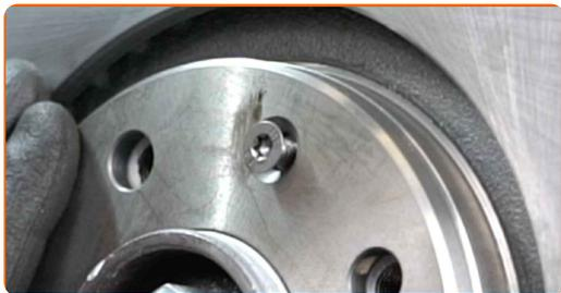
**25** Serrez les fixations du disque de frein. Utilisez la mèche Torx T30. Utilisez une clé dynamométrique. Serrez-le jusqu'à 10 Nm.
