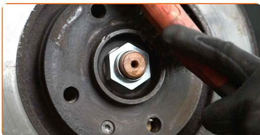
**18** Dévissez les fixations du disque de frein. Utilisez la mèche Torx T30. Utilisez une clé à cliquet.
