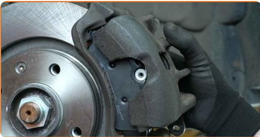
**34** Installez les boulons de fixation.
