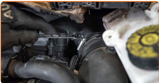
**6** Desserrez les trois vis de fixation du couvercle de filtre à air. Utilisez la mèche Torx T25. Utilisez une clé à cliquet.
