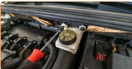
**4** Retirez le réservoir à liquide de frein. Mettez-le de côté.
