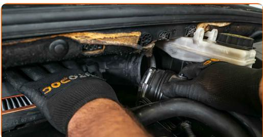
**15** Reserrez l'anneau de serrage et les fixations sur le tuyau d'admission du filtre à air. Utilisez une clé mixte de No.7.
