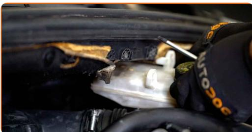
**5** Dévissez l'anneau de serrage et les fixations du tuyau d'admission du filtre à air. Utilisez une clé mixte de No.7.
