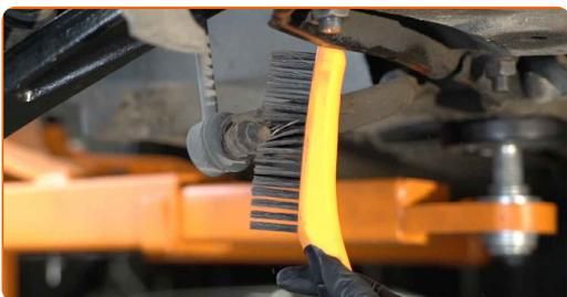
**10** Dévissez la fixation reliant la biellette à la barre stabilisatrice. Utilisez une clé mixte de No.16 Utilisez une douille n° 15. Utilisez une clé à cliquet.
