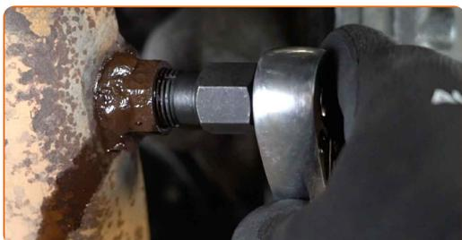
**9** Appliquez du produit sur la sonde lambda. Utilisez de la graisse au cuivre.
