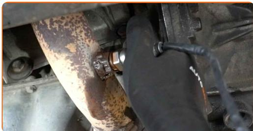
**11** Serrez la fixation de la sonde lambda. Utilisez une clé mixte de No.22 Utilisez une clé dynamométrique. Serrez-le jusqu'à 47 Nm.
