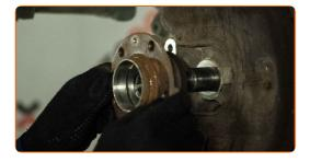
Installez le nouveau moyeu de roue avec un roulement. Servez-vous d'un maillet en caoutchouc.
