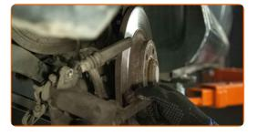
Serrez le support de l'étrier de frein. Utilisez la mèche Torx T55. Utilisez une clé dynamométrique. Serrez-le jusqu'à 108 Nm.
