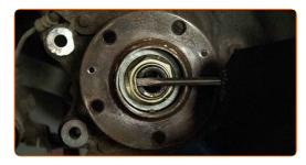
Retirez le moyeu et le roulement puisqu'ils forment un bloc hermétique.
