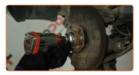
Retirez l'écrou de fixation.
