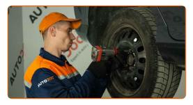
Abaissez la voiture et serrez les boulons de roue en ordre croisé. Servez-vous d'une douille à choc pour roue N°19. Utilisez une clé dynamométrique. Serrez-le jusqu'à 100 Nm.
