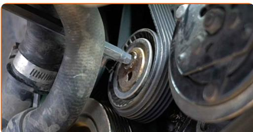
**13** Mettez de côté la poulie de tendeur de la courroie en V crantée. Utilisez une rallonge de barre d'entraînement carrée 1/4". Utilisez une clé à cliquet.
