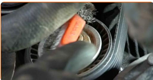
**12** Desserrez l'attache du galet tendeur. Utilisez la clé HEX n° H8. Utilisez une clé à cliquet.
