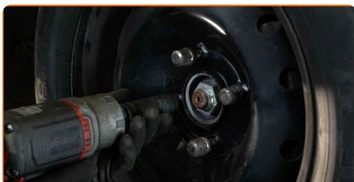
**24** Abaissez la voiture et serrez les boulons de roue en ordre croisé. Servez-vous d'une douille à choc pour roue N°19. Utilisez une clé dynamométrique. Serrez-le jusqu'à 90 Nm.
