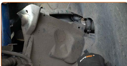
**10** Détachez les fixations de la conduite de liquide de refroidissement.
