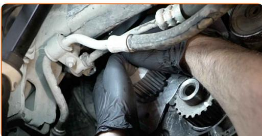
**70** Vissez les fixations de la pompe à eau. Utilisez une douille n° 11. Utilisez une clé à cliquet.
