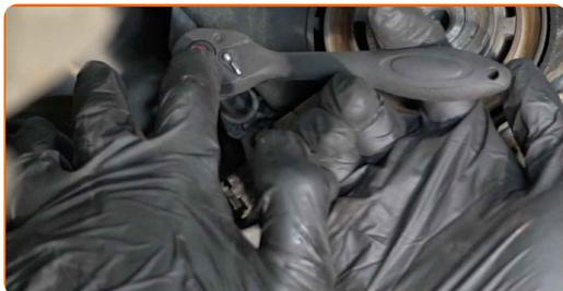
**43** Dévissez la fixation du capteur de position du vilebrequin. Utilisez une douille n° 10. Utilisez une clé à cliquet.
