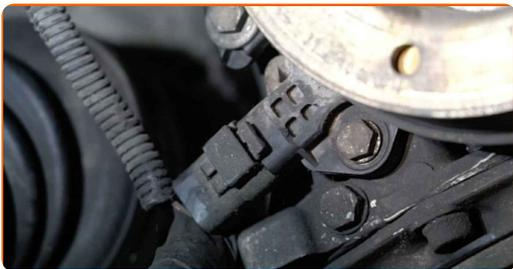
**103** Attachez le câblage du capteur de position du vilebrequin.
