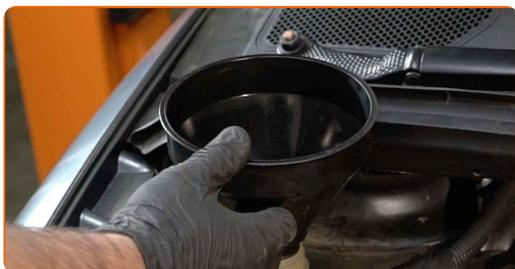
**134** Versez du liquide de refroidissement dans le réservoir.
