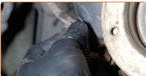
**104** Mettez de côté la poulie de tendeur de la courroie en V crantée. Utilisez une clé mixte de No.15
