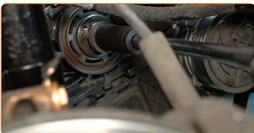
**87** Faites tourner l'engrenage du vilebrequin. Utilisez une douille n° 22. Utilisez une clé à cliquet.
