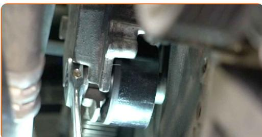
**55** Retirez le galet enrouleur de la courroie de distribution de son emplacement de montage.
