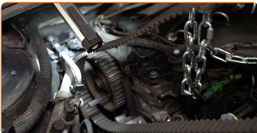
**54** Desserrez la fixation du galet enrouleur de la courroie de distribution. Utilisez une clé mixte de No.15
