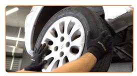
Remplacement : roulement de roue – CITROËN Xantia Break (X1\_, X2\_). Les professionnels recommandent :
