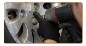
Abaissez la voiture et serrez les boulons de roue en ordre croisé. Utilisez une clé dynamométrique. Serrez-le jusqu'à 100 Nm.
