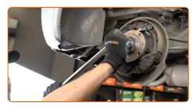
Retirez le moyeu et le roulement puisqu'ils forment un bloc hermétique. Servez-vous d'un extracteur d'engrenage à 3 bras.
