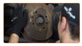
Serrez les fixations des tambours de frein. Utilisez la mèche Torx T30. Utilisez une clé dynamométrique. Serrez-le jusqu'à 10 Nm.
