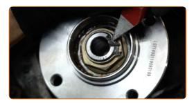
Appliquez une graisse spéciale sur l'emplacement du palier de roulement. Utilisez de la graisse au cuivre.
