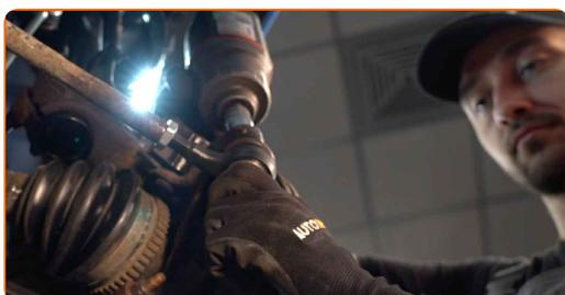
**18** Serrez l'écrou de blocage de l'extrémité de la barre. Utilisez une clé mixte de No.20 Utilisez une clé mixte de No.22 Utilisez une clé dynamométrique. Serrez-le jusqu'à 55 Nm.
