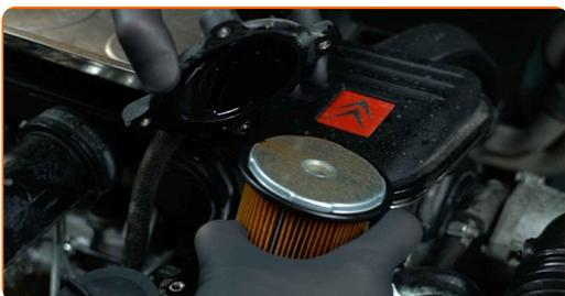
Remplacement : filtre à carburant – CITROËN XM (Y4). AUTODOC recommande :
