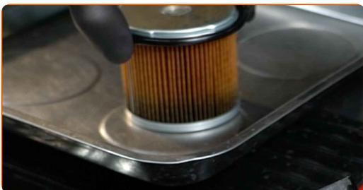
**8** Pompez le carburant hors du boîtier du filtre à carburant. Utilisez une seringue à huile manuelle.
