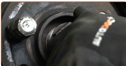
**78** Resserrez l'écrou de l'arbre de transmission. Utilisez une douille n° 36. Utilisez une clé dynamométrique. Serrez-le jusqu'à 320 Nm.
