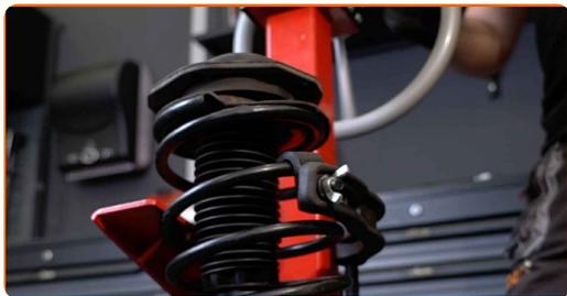
**54** Lubrifiez la barre d'amortisseur. Utilisez de la graisse au cuivre.
