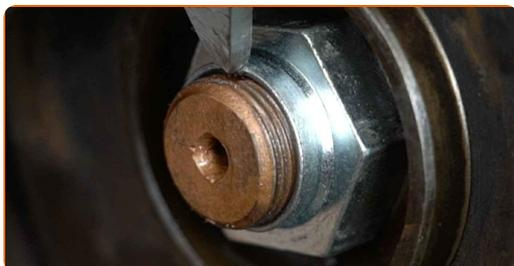
**80** Appliquez du produit sur la fixation du joint à rotule. Appliquez du produit sur la fixation reliant la jambe de suspension à la fusée d'essieu. Appliquez du produit sur la fixation qui relie la biellette de barre stabilisatrice à la jambe de suspension. Utilisez de la graisse au cuivre.
