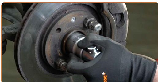
**20** Retirez l'écrou de fixation.
