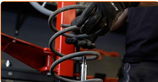
**46** Retirez l'amortisseur usagé du compresseur à ressort hydraulique hélicoïdal.
