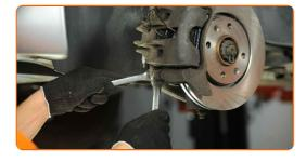
Branchez le fil du capteur d'usure de plaquette de frein.
