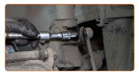
Dévissez la fixation reliant la biellette à la barre stabilisatrice. Utilisez une douille n° 14. Utilisez une clé à cliquet.
