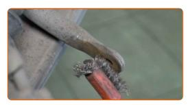
Installez une nouvelle biellette de barre stabilisatrice et serrez les fixations.
