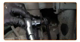
Serrez la fixation reliant la biellette à la barre stabilisatrice. Utilisez une douille n° 17. Utilisez une clé dynamométrique. Serrez-le jusqu'à 35 Nm.
