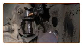
Serrez la fixation reliant la biellette à l'amortisseur. Utilisez une douille n° 17. Utilisez une clé dynamométrique. Serrez-le jusqu'à 35 Nm.
