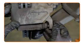
Serrez les fixations de l'étrier de frein. Utilisez une clé mixte de No.17. Utilisez une douille n° 13. Utilisez une clé dynamométrique. Serrez-le jusqu'à 35 Nm.
