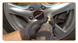
Abaissez la voiture et serrez les boulons de roue en ordre croisé. Servez-vous d'une douille à choc pour roue N°19. Utilisez une clé dynamométrique. Serrez-le jusqu'à 108 Nm.
