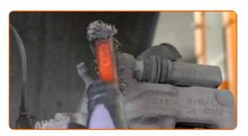
Dévissez les fixations des étriers de frein. Utilisez une clé mixte de No.15. Utilisez une douille n° 13. Utilisez une clé à cliquet.
