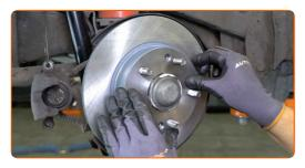
28 Installez les boulons de fixation.
