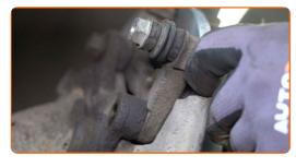
32 Installez les boulons de fixation.
