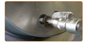
Serrez les fixations du disque de frein. Servez-vous d'un tournevis Phillips. Utilisez une clé dynamométrique. Serrez-le jusqu'à 10 Nm.
