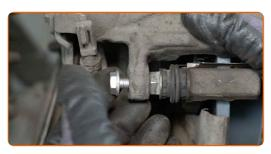
Serrez les fixations de l'étrier de frein. Utilisez une clé mixte de No.15. Utilisez une douille n° 13. Utilisez une clé dynamométrique. Serrez-le jusqu'à 35 Nm.
