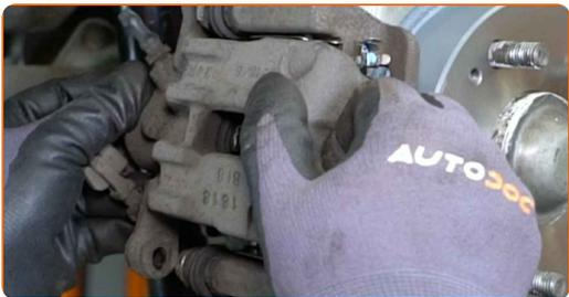
**22** Installez les boulons de fixation.
