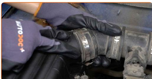
**15** Vissez le collier de fixation reliant le conduit d'air au boîtier de filtre à air. Servez-vous d'un tournevis Phillips.
