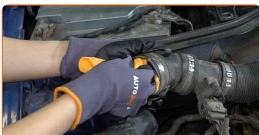
**6** Déverrouillez les clips du couvercle du filtre à air.
