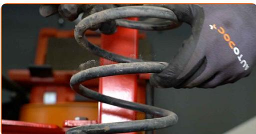
**27** Retirez l'amortisseur usagé du compresseur à ressort hydraulique hélicoïdal.
