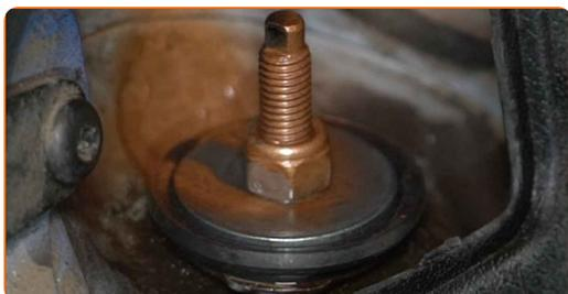
39 Installez le bouchon de protection sur le support de l'amortisseur.
