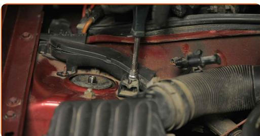
**15** Détachez le faisceau de câbles du moteur.
