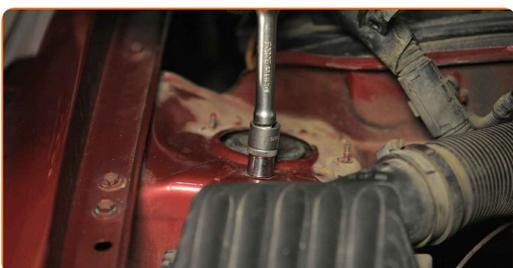
Remplacement : ressort de suspension – Opel Corsa S93. AUTODOC recommande :
