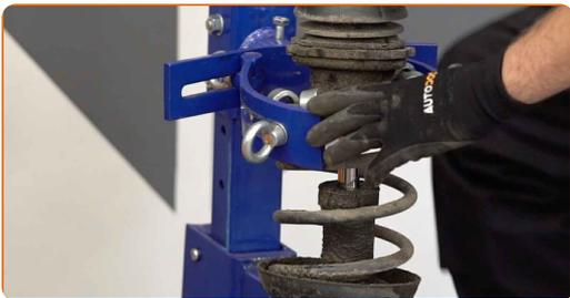
Remplacement : ressort de suspension – Opel Corsa S93. Conseil d'AUTODOC
