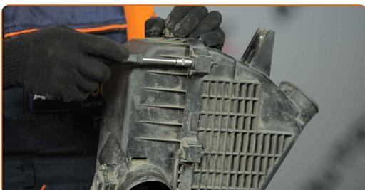
17 Réinstallez le compartiment du filtre à air.
