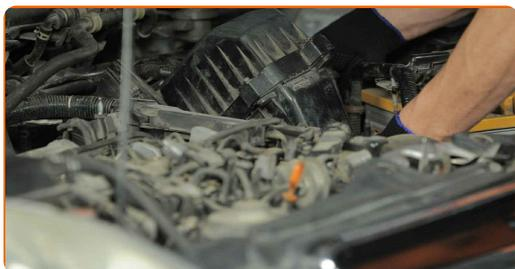
18 CVissez les boulons de fixation du compartiment filtre. Utilisez une douille n° 10. Utilisez une clé à cliquet.
