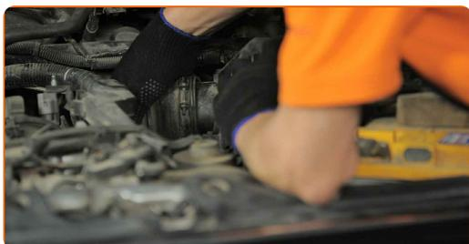
20 Serrez le collier de serrage sur la durite d'admission d'air. Utilisez une douille n° 5.5. Utilisez une clé à cliquet.
