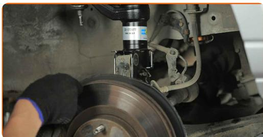
**44** Installez les boulons de fixation (2 pièces). Utilisez une clé à cliquet.
