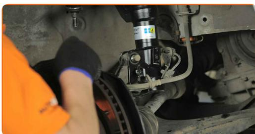
**45** Serrez les fixations inférieures qui relient l'amortisseur à la fusée d'essieu. Utilisez une clé mixte de No.19. Utilisez une douille n° 22. Utilisez une clé dynamométrique. Serrez-le jusqu'à 157 Nm.
