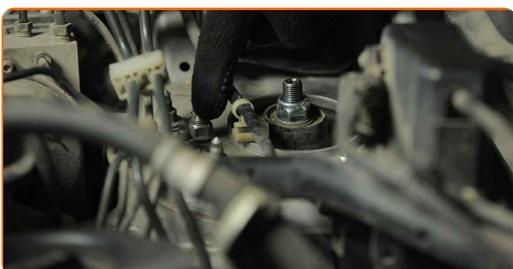
**22** Dévissez l'attache supérieure du support de l'amortisseur. Utilisez une douille n° 14. Utilisez une clé à cliquet.
