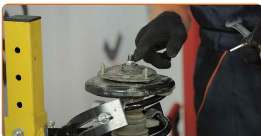
**27** Retirez l'écrou de la tige de piston de l'entretoise. Utilisez une clé mixte de No.19. Utilisez la clé HEX n° H7. Utilisez une clé à cliquet.
